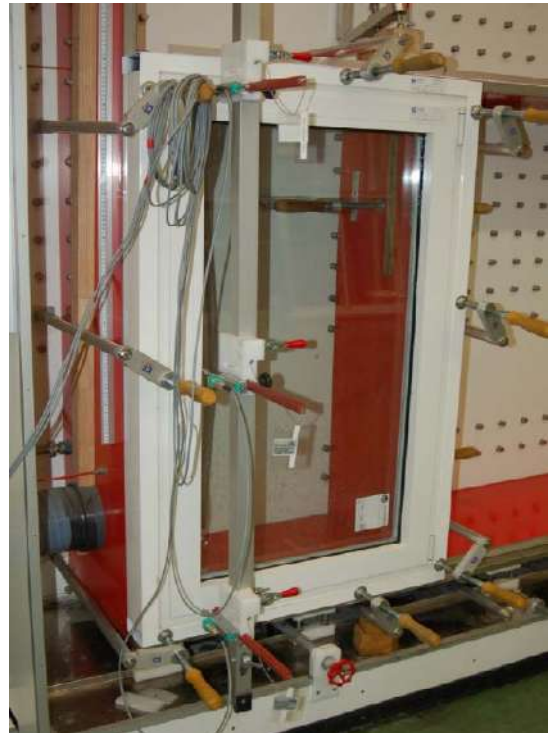
ENSAYO DE DEFORMACIÓN POR EMPUJE DE VIENTO
