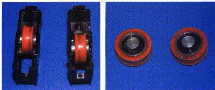
Rodamientos después de 25.000 ciclos con 30 kg/rodamiento
